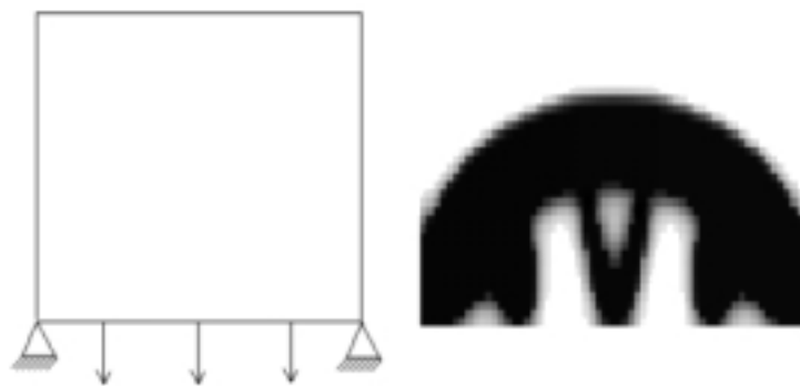
Figura 3: Geometria e topologia obtida para o problema bi-apoiado com três cargas.
